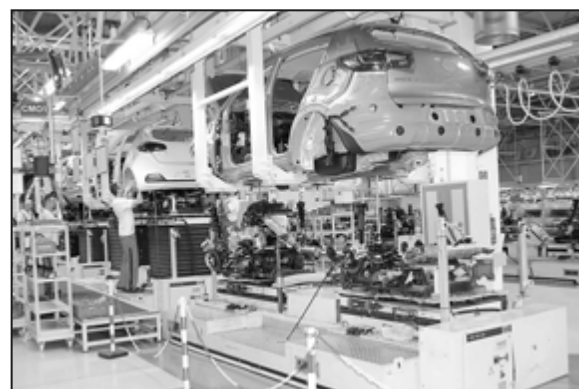
Táto operácia sa volá „podvozkový sobáš“. Predná náprava s motorom je primontovaná k podvozku karosérie.
